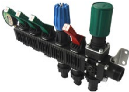
Gruppo ECOCONTROL completi con valvola di regolazione massima pressione a membrana e valvola generale ad annullo pressione ad otturatore , valvola regolazione pressione proporzionale ECOCONTROL units fitted with diaphragm pressure relief valve, main on/off valve with shaped poppet offering pressure bleeding off function, volumetric valve and section valves
